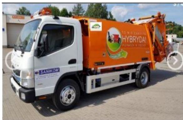
Partner 8m 3 DMC 9-11 t ładowność 2,5t, z aparatem zasypowym tylnym
