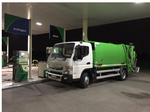
Partner 8m 3 DMC 9-11 t ładowność 2,5t, z aparatem zasypowym tylnym
